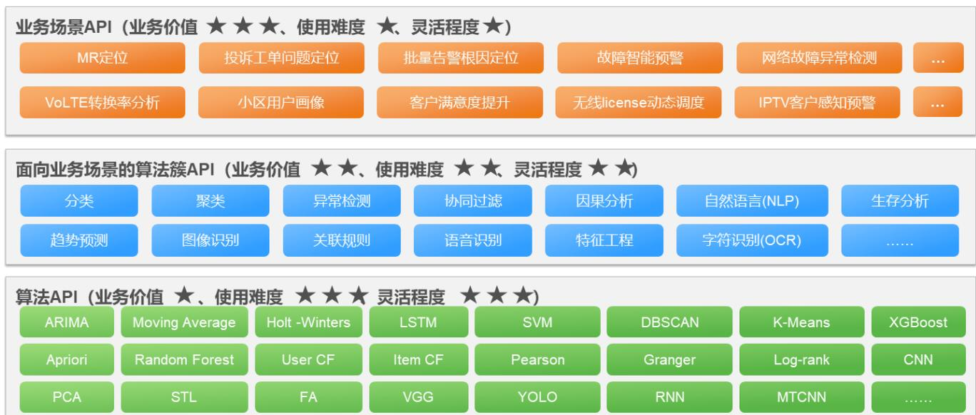
图3 人工智能和机器学习引擎三层API体系
