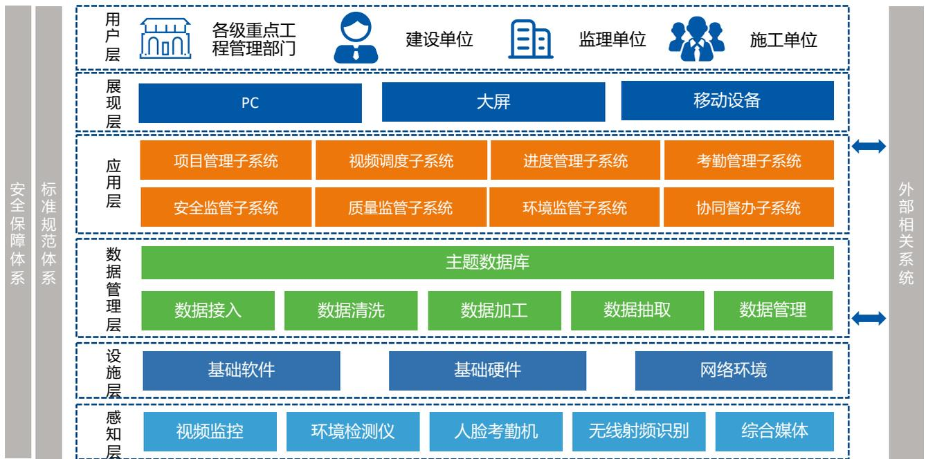
重点工程智慧监管平台整体架构总共分为五层：感知层、设施层、数据管理层、应用层、展现层、用户层，并全程贯穿安全保障体系和标准规范体系。
